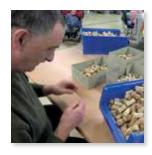
Die Korken werden auf eine bestimmte Korngröße geschreddert. Das daraus entstandene Granulat wird zu Dämmstoffen weiterverarbeitet. Es wird für den Neubau und die Sanierung von Häusern, als natürliche und schadstoffarme Isolierung, Boden- oder Wandverkleidung verwendet. Auch Pinnwände werden daraus hergestellt.
