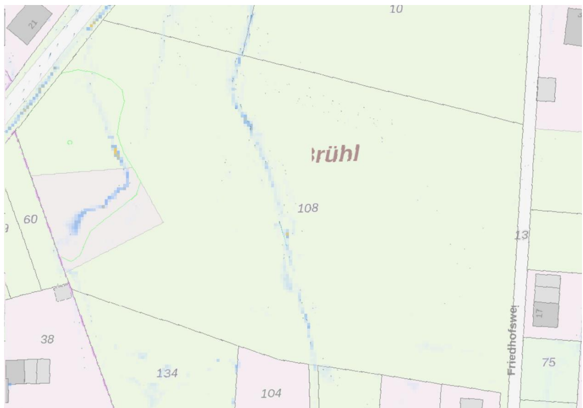
Abbildung 4: Auszug aus dem Hochwasserportal des Kreises Euskirchen (Starkregen SRI 9/10 mit 90l/m 2 in einer Stunde)
